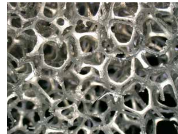
Vlevo: Porézní kovy Vpravo: Detail struktury kovové pěny.
