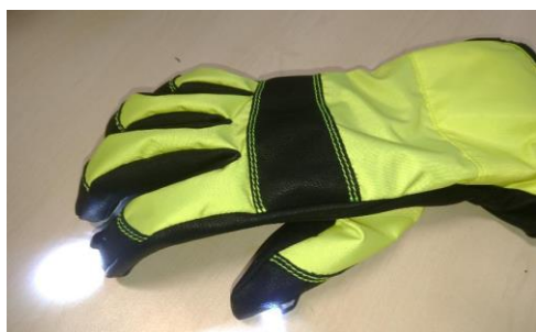
Obrázek 1.: Rukavice s integrovaným osvětlením a bezdrátovým dobíjením pomocí rezonanční induktivní vazby
