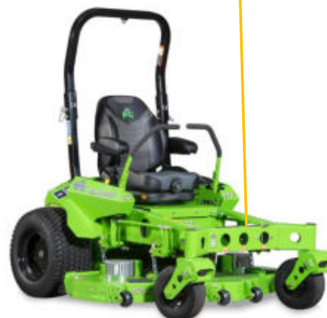
Světelné indikátory LED břitu (1 indikátor na rotor/břit)
