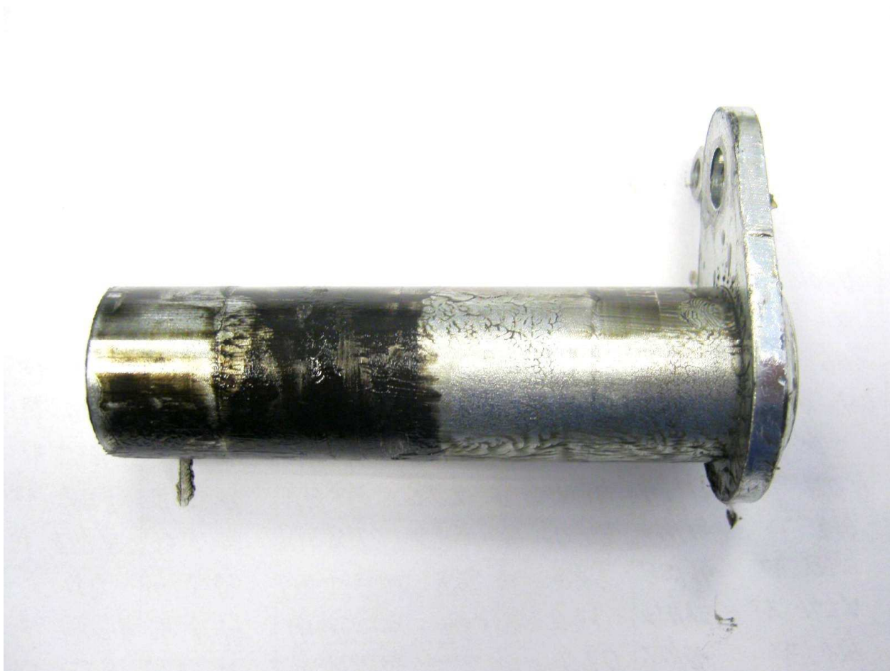
Foto č.20 – horní čep válce namazaný mazivem POLYMER 400
