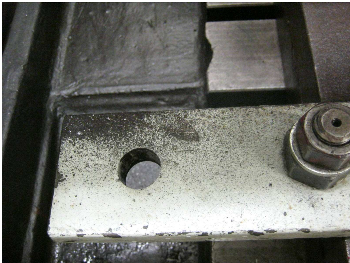
Foto č.3 – otěr pod čepem namazaným mazivem Rolsfer EP_Nanotech N1 GH – X
