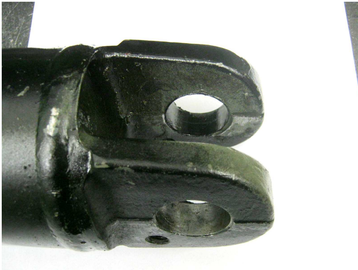
Foto č.23 – vidlice válce s mazivem Rolsfer EP_Nanotech N1 GH – X
