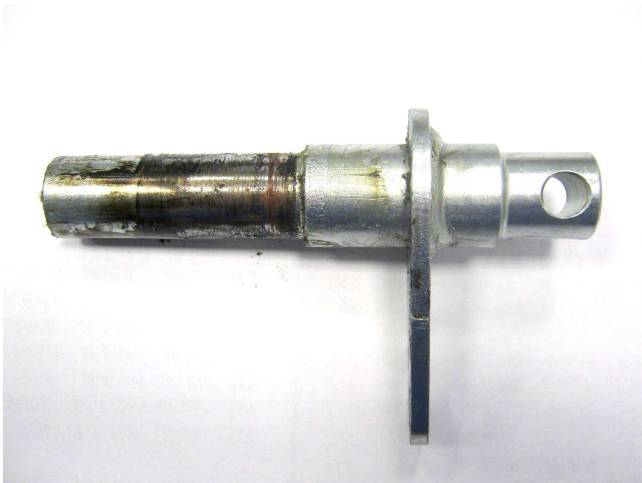
Foto č.9 – horní čep zvedacího táhla namazaný mazivem Rolsfer EP_Nanotech N1 GH – X
