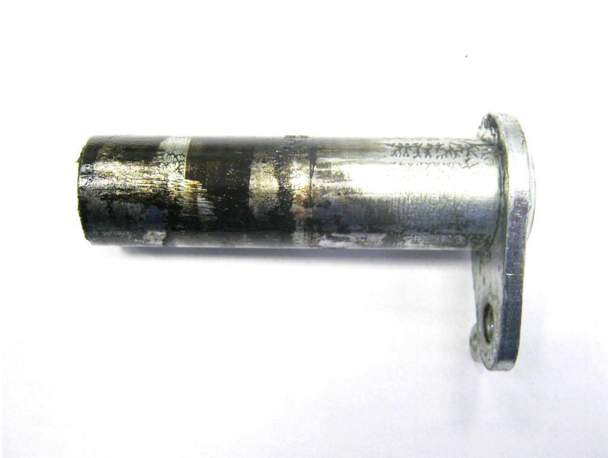
Foto č.18 – horní čep válce namazaný mazivem POLYMER 400
