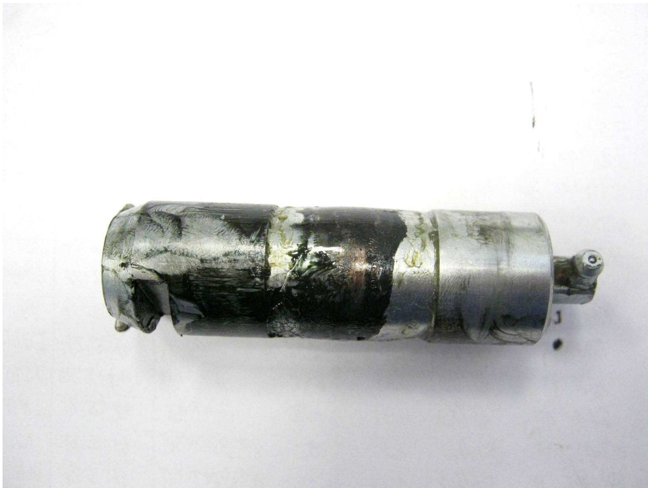
Foto č.15 – spodní čep válce namazaný mazivem Rolsfer EP_Nanotech N1 GH – X
