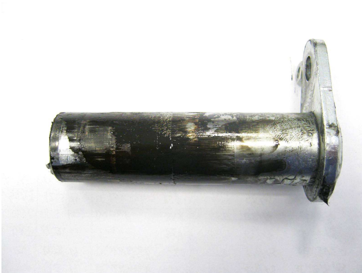
Foto č.17 – horní čep válce namazaný mazivem Rolsfer EP_Nanotech N1 GH – X
