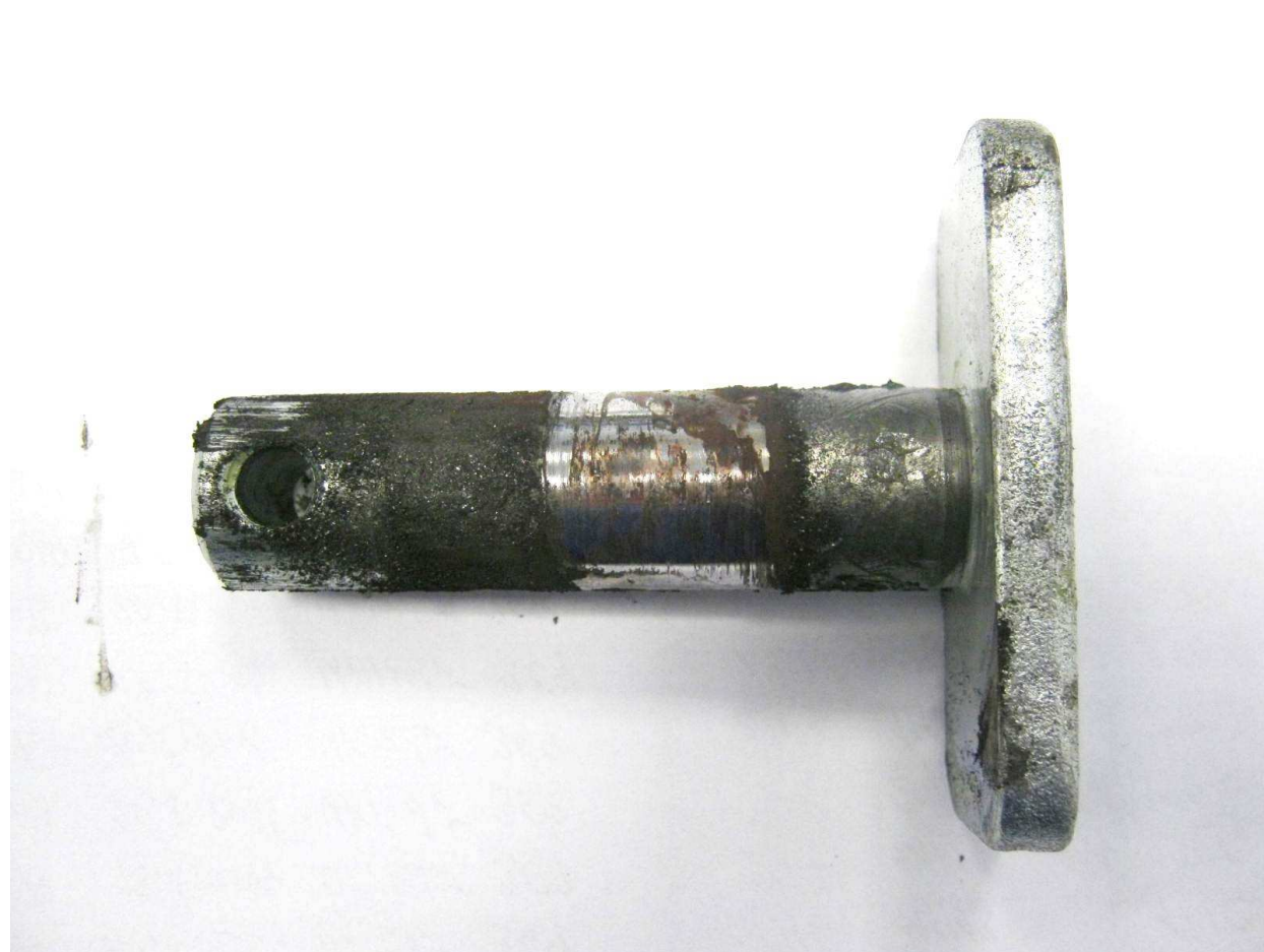
Foto č.6 – spodní čep zvedacího táhla namazaný mazivem POLYMER 400
