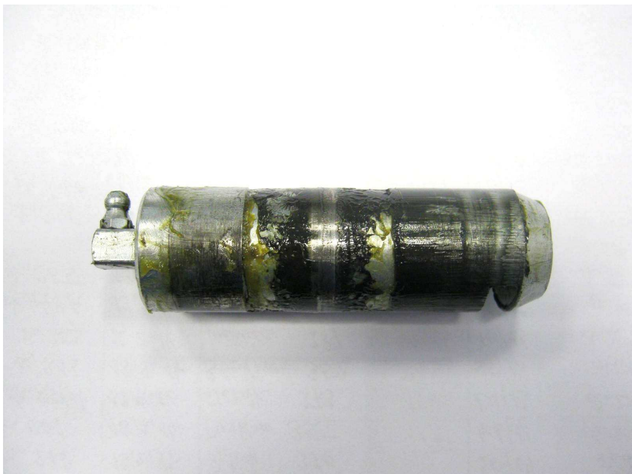
Foto č.14 – spodní čep válce namazaný mazivem POLYMER 400
