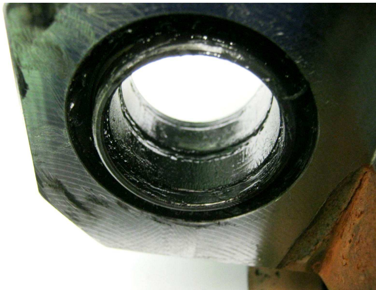
Foto č.22 – oko pístonice s mazivem POLYMER 400
